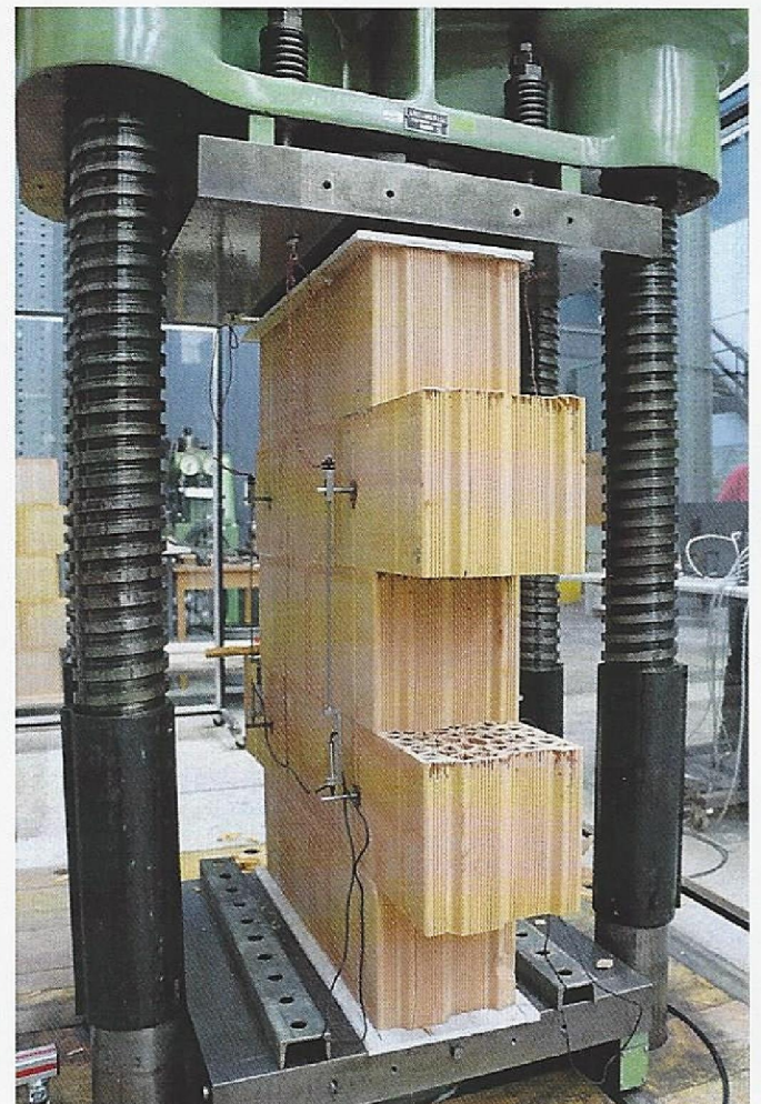
Abbildung 7: Rückseite des Mauerwerkskleinkörper Nr. 1 nach dem Versuch.
