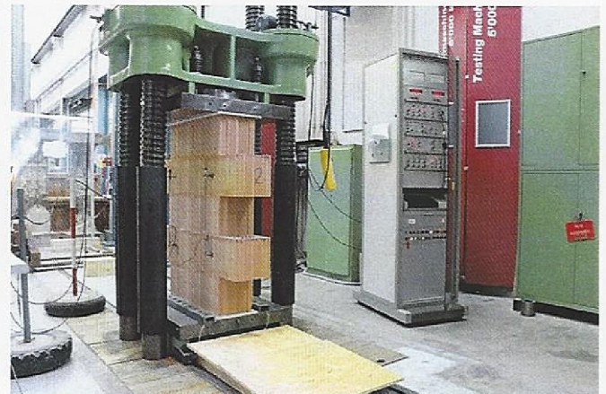
Abbildung 3: Mauerwerkskleinkörper Nr. 2 eingebaut in der 5000 kN Druck-Prüfmaschine.
