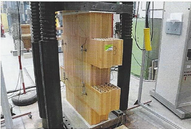
Abbildung 10: Mauerwerkskleinkörper Nr. 3 nach dem Versuch.
