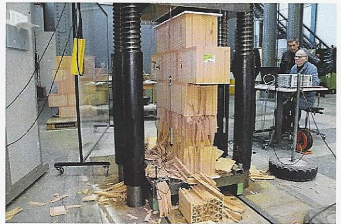
Abbildung 9: Rückseite des Mauerwerkskleinkörper Nr. 2 nach dem Versuch.
