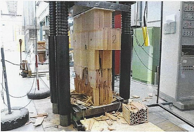
Abbildung 8: Mauerwerkskleinkörper Nr. 2 nach dem Versuch.
