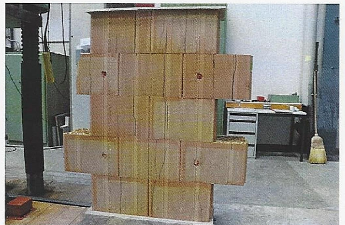
Abbildung 11: Mauerwerkskleinkörper Nr. 3 nach dem Versuch, nach Abbau der Weggeber und aus der Prüfmaschine herausgefahren. Risse angezeichnet.
