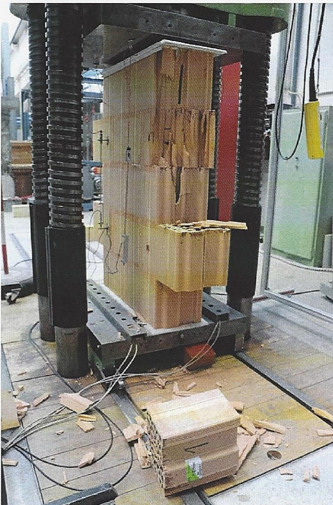
Abbildung 6: Mauerwerkskleinkörper Nr. 1 nach dem Versuch.
